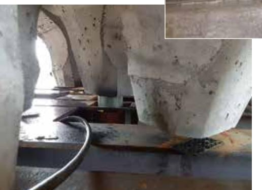
中心部のブロックに対して下部方向より油圧ジャッキで押抜きました。その結果、各ブロックはせん断することなく 6.7kN で一様に持ち上がりました。
