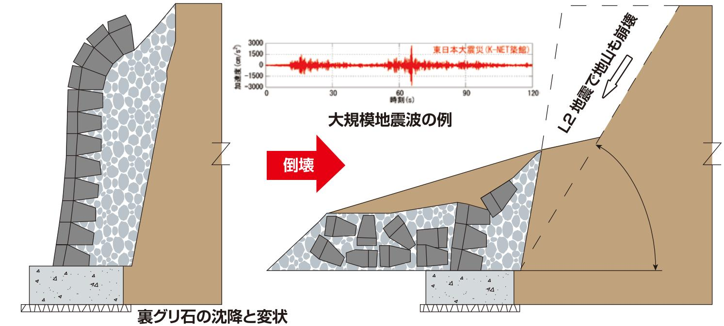
度重なる雨水侵入や地震履歴による裏グリ石の沈降や背面地山の変状は、石積み壁面に『はらみ出し』を発生させて擁壁の面状を不安定化し、その後に発生する地震により倒壊に至ります。大規模地震では背面地山も同時に崩壊した多くの事例報告もあります。
