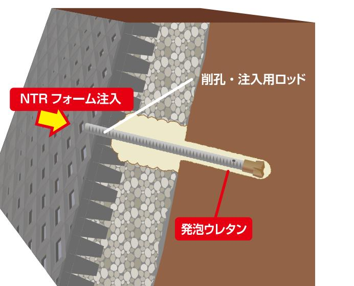
自然災害による石積み・ブロック積み擁壁の倒壊を最小限に食い止めることを目的とした画期的な工法
