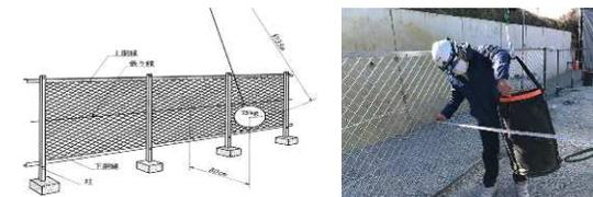
※JIS A 6518 (ネットフェンス構成部材)に規定する強度試験
