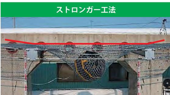
・補強した衝突スパン両側の支柱(120kJ)
